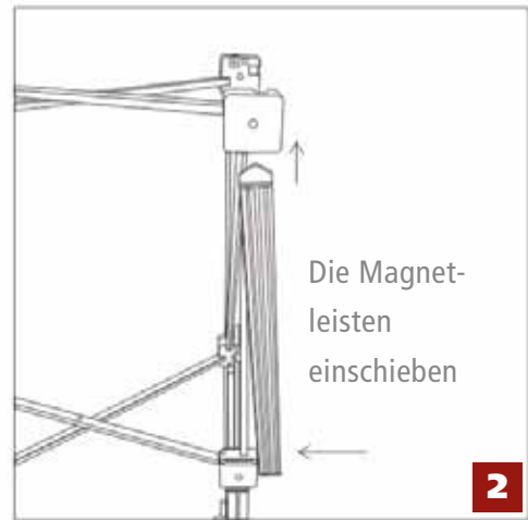
Anbringen der Magnetleisten
